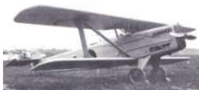
88式偵察機：昭和3年採用、満州事変から日中戦争初期まで活躍し、昭和初期を代表する陸軍機で、生産機数1,117(含軽爆型)は当時の国産機としては破格の数を誇る。 エンジン：川崎一式450馬力発動機(BMW-6)水冷V型2気筒 速度：最大220km/h 航続時間：最大6時間 武装：7.7mm後方旋回機銃1(軽爆型の爆弾最大200kg)
