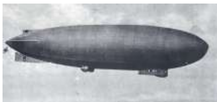
押収格納庫内のSS型飛行船; イギリス製の軟式飛行船。軟式飛行船は木綿や化学繊維にゴムを塗布して、大きな袋を作り、その中に水素ガスを詰めこんだもので、内部の圧力だけで船形を保っている。
